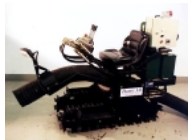
Hydraulik, ventiler och sits monterat på larven.
